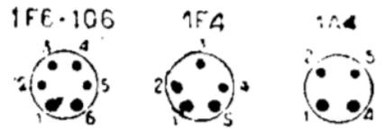
ATTACCHI DELLE VALVOLE [visti di sotto]
